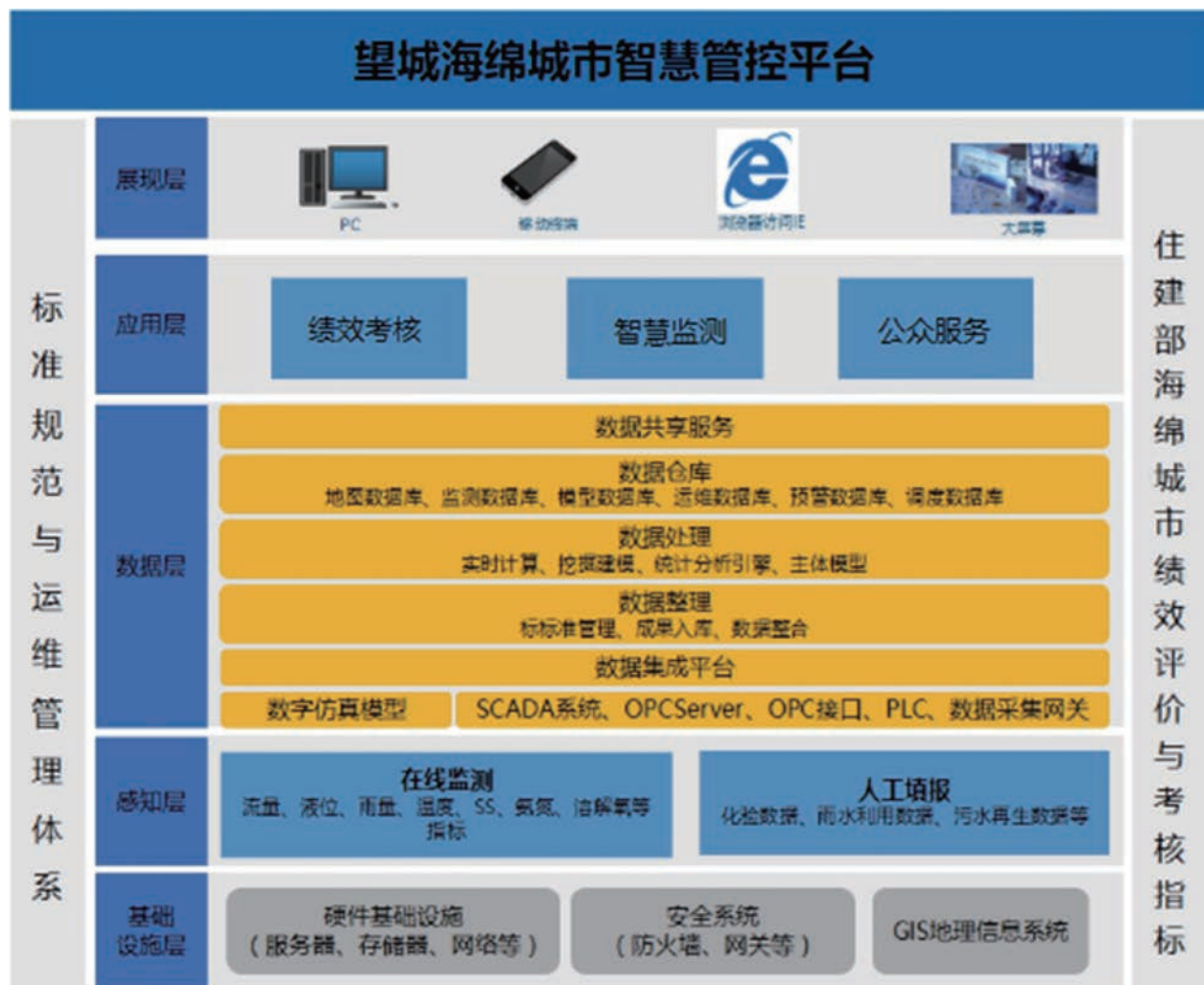
图1 海绵城市智慧管控平台总体架构图
